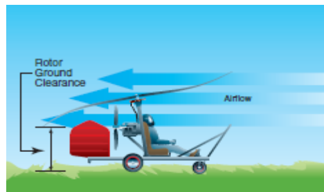
2.10. Irudia: Autojiroaren gaineko aire-fluxua aireratzean
