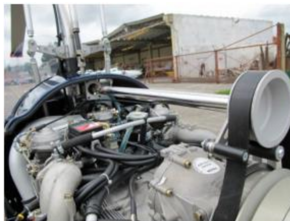
2.47. Irudia: kardan bidezko abiarazte mekanismoa
