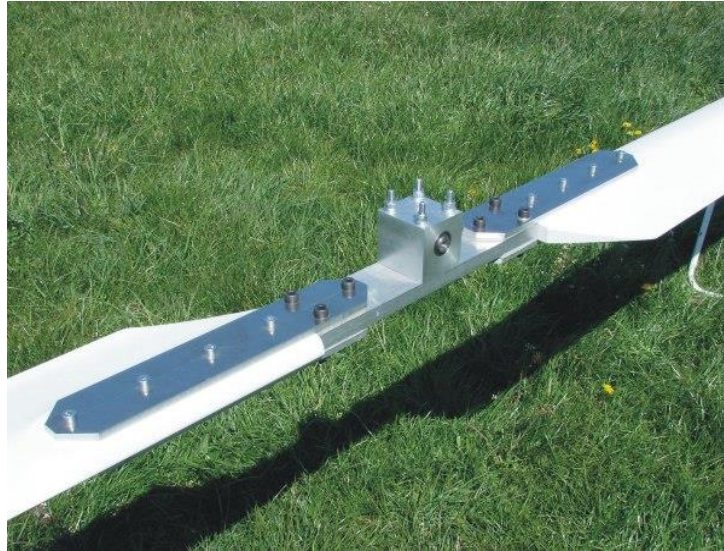
2.7. Irudia: Disko errotorea balantzin eta palekin
