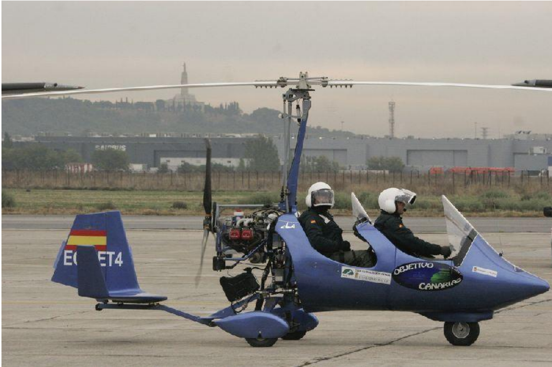
2.8. Irudia: Lurrean geldia, autojiroaren palak flexionatuta
