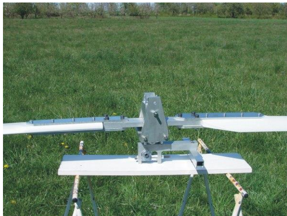
2.27. Irudia: Disko errotorea kontrolerako multzoarekin
