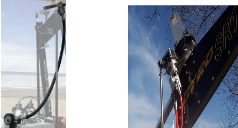
2.9. Irudia: Prerrotadore hidrauliko bat, motorrera eta engranai platerera lotuta
