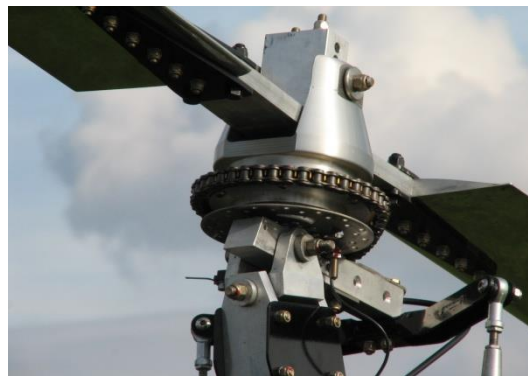
2.42. eta 2.43. Irudiak: Teeter Stand eta Bearing Block-a barneraturik
