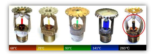
Figura 24. Relación de colores de ampollas y temperaturas a las que explotan [34]
