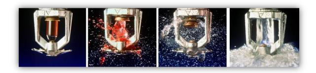
Figura 23. Secuencia de activación de un rociador automático [34]
