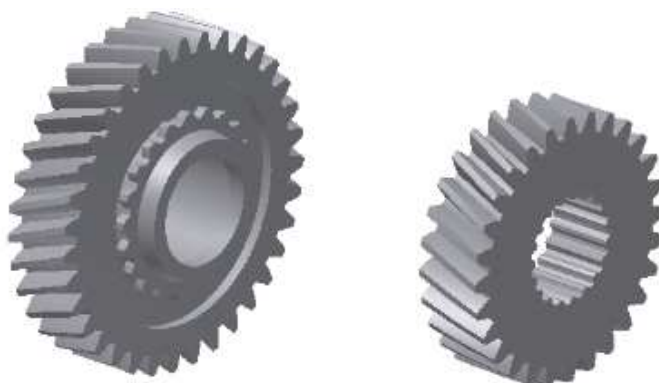
2.45 irudia: Hortz helikoidaleko gurpil askea eta finkoa
