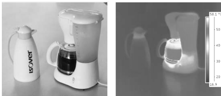
Figura 2.10. Símil de funcionamiento de una vivienda convencional mal aislada y una vivienda Passivhaus: una cafetera (derecha) y un termo (izquierda) vistas mediante una cámara termográfica [DECEUNINCK, COBBAERT 2008].
