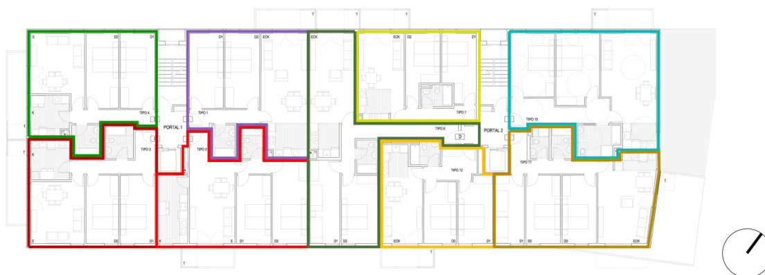
Figuras 9.1. Proyecto de 33 viviendas VPO Parcela a.300/2, área nº36, Muliarte. Hondarribia. Euskal TYM S.L. promovido por VISESA. Planta tipo con 9 viviendas, en la fila norte tipo [N_o], [N_], [n_s_], [N_] y [Ne_] y en la fila del sur [_So], [_S_], [n_s_], [_S_] y [eS_] 2
