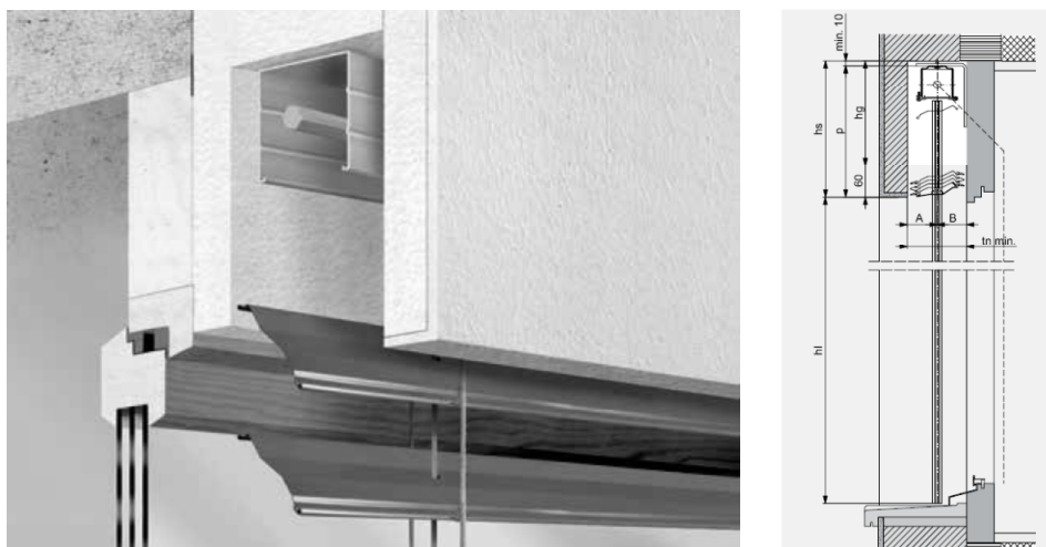
Figura 5.34. Sistema de protección solar Lamisol de Griesser [Griesser].
