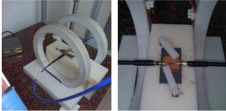
**Figura 2.5:** Bobinas de Helmholtz con el portamuestras (y la película delgada fijada en él) en su interior. Situado céntricamente de forma que el  $\vec{H}_{dc}$  sea lo más homogéneo posible.
