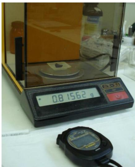
Figura 4.6: Fotografía de la balanza analítica utilizada para la medida de pérdida de peso de los ferrogel con una muestra de ferrogel dentro de ella.
