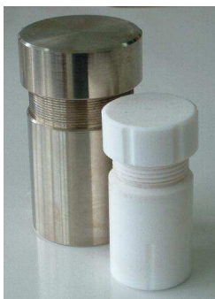
Fig. 7. Recipiente de politetrafluoroetileno empleado en síntesis hidrotermal junto con su carcasa de acero, que evita su deformación.
