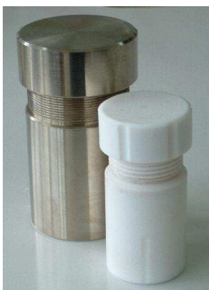
Fig. B.1. Recipiente de teflón, junto con su correspondiente carcasa de acero, empleados en la síntesis hidrotermal.
