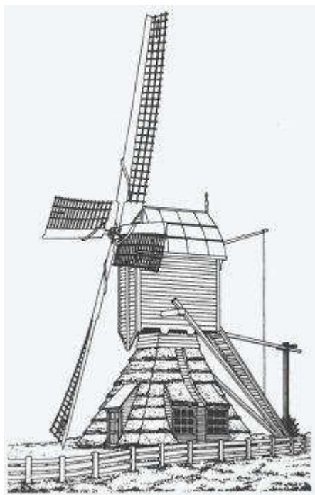
Figura 18. Trípode recubierto en forma de almacén.
