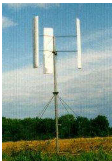
Figura 62. Aerogenerador de eje vertical tipo Giromill.
