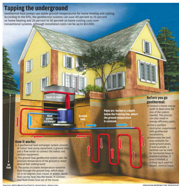
Figura 1. Esquema de funcionamiento de la energía geotérmica.
