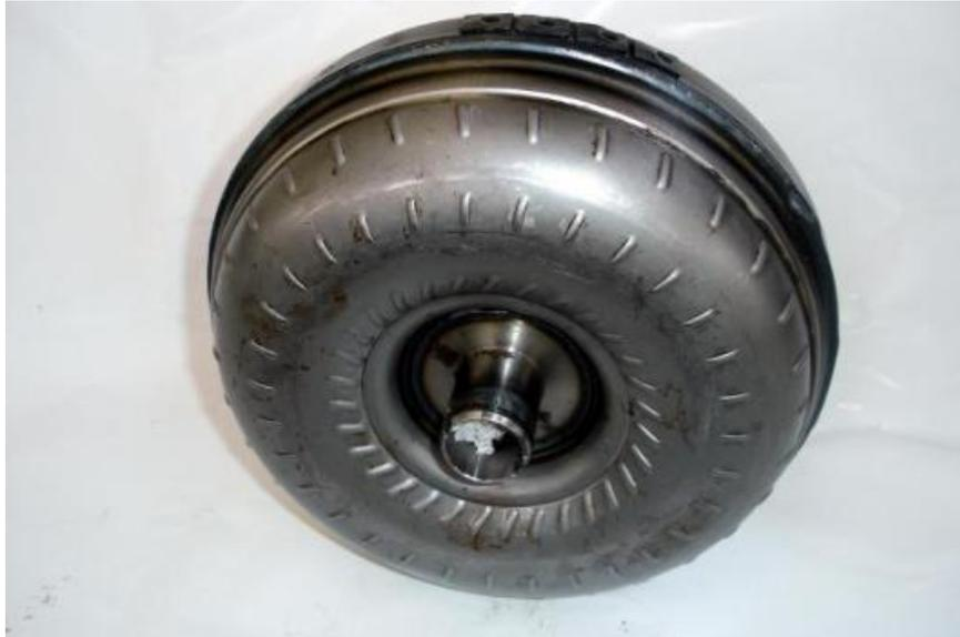
**Figura 24:** Convertidor de Par
