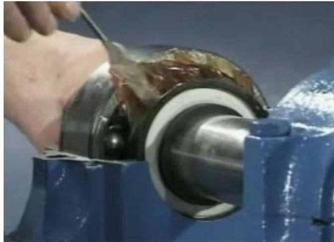
Figura 33: Lubricación de un Rodamiento
