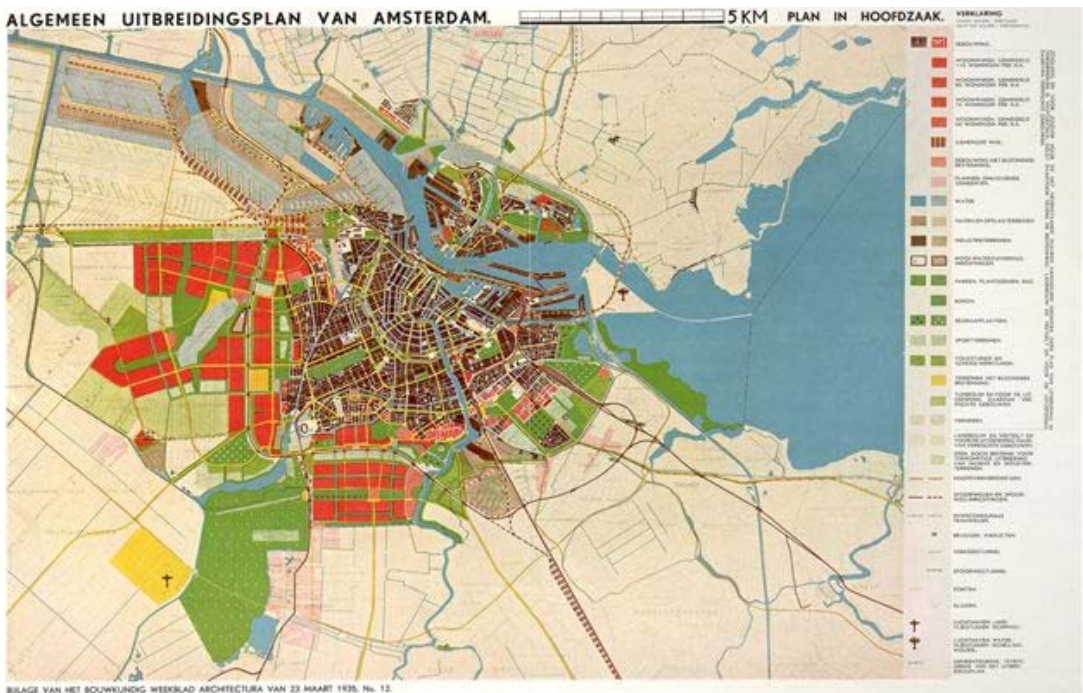
ÁMSTERDAM, PLAN REGULADOR DE 1935. En anaranjado las ampliaciones previstas, en marrón lo existente. Continuidad y evolución. Creación del gran parque del sur xlvii
