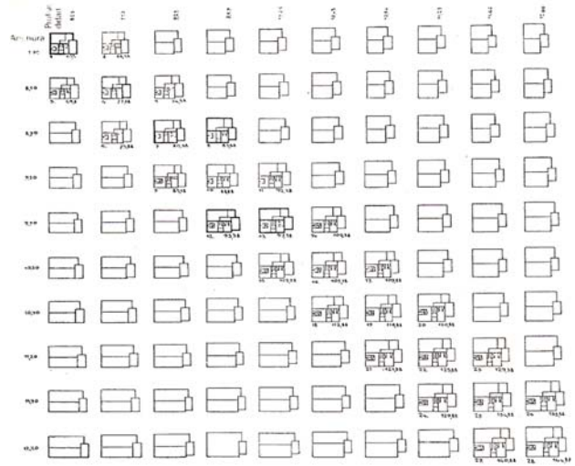
ESTUDIOS DE ASOLEAMIENTO, fundamental entonces en las estancias de permanencia. Gráfico para determinar la relación fachada-profundidad para distintas superficies de vivienda lxvii
