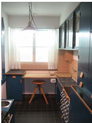
FRANKFURTER KÜCHE DE SCHÜTTE –LIHOTZKY, RECONSTRUCCIÓN Y PLANTA. Zonificación de cada tipo de trabajo, superficies específicas para cada tarea. Diseño de complementos particularizados para cada función bix
