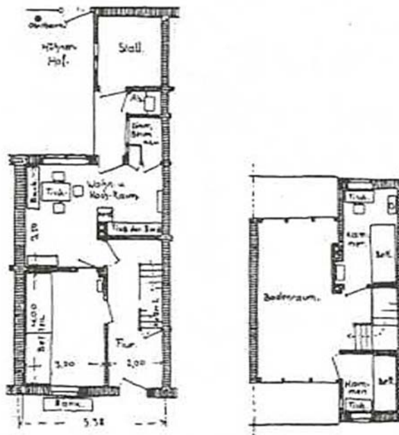
VIVIENDAS NORMALIZADAS PARA LA CIUDAD JARDÍN DE HELLERAU, DISEÑADAS POR HENRICH TESSENOW EN 1906. La estructura era un entramado de madera de 5,40m de crujía xiii
