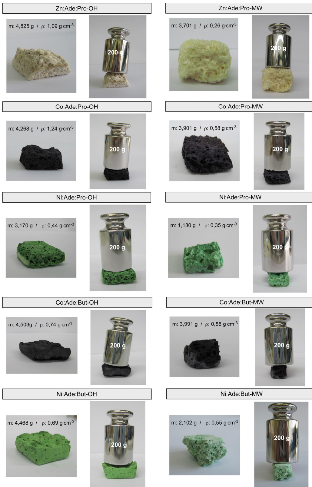
Figura 4.10. Fotografías de los monolitos de los sistemas M II /adeninato/monocarboxilato (M II : Co, Ni, Zn) mostrando datos de su masa, densidad y resistencia frente a la fuerza compresiva que ejerce una pesa de 200 g.
