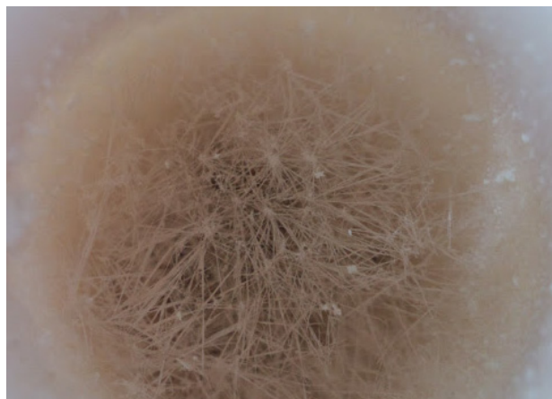
Figura 3.17. Imagen de los cristales de 2-metilimidazol condensados en las paredes del reactor de PTFE después de su sublimación en la síntesis del ZIF-8 mediante calentamiento por microondas.
