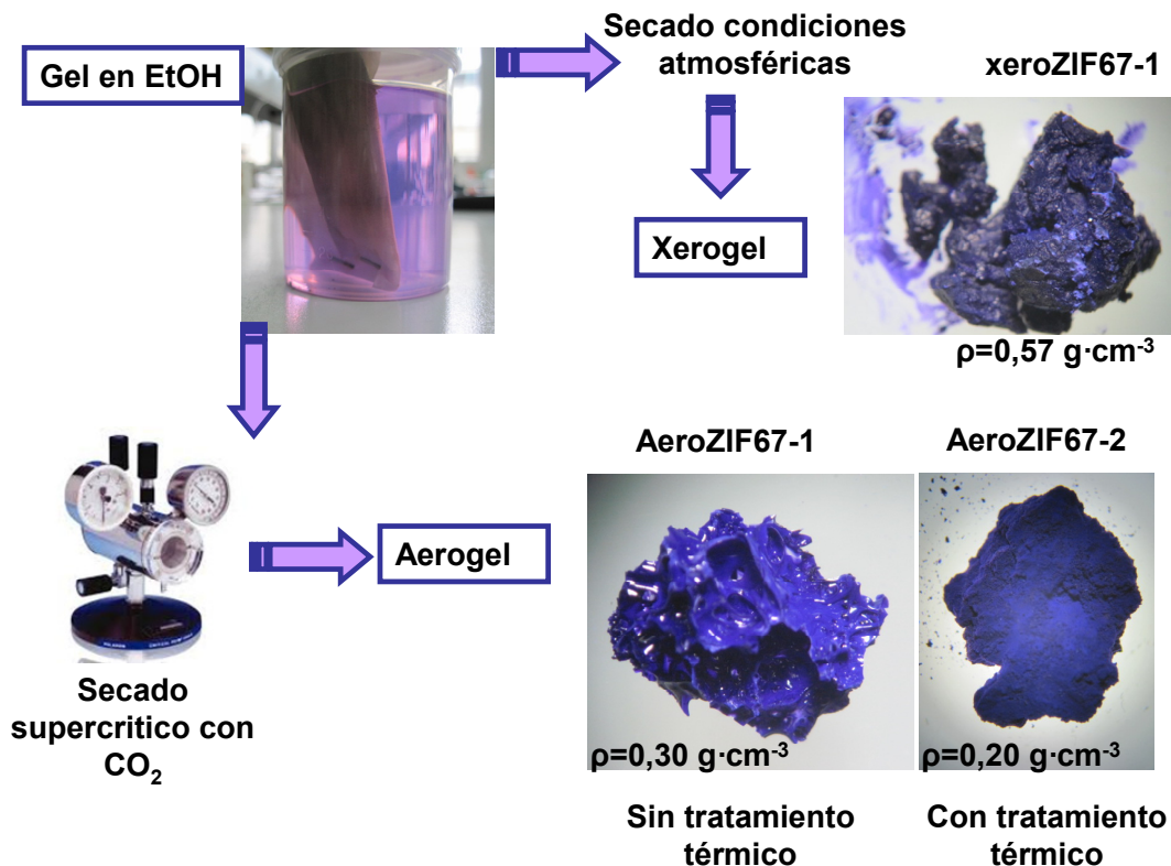
Figura 6.3. Imágenes del gel de ZIF-67 en etanol durante el proceso de lavado, y de los aerogeles (aeroZIF67-1 y -2) y del xerogel (xeroZIF67-1).
