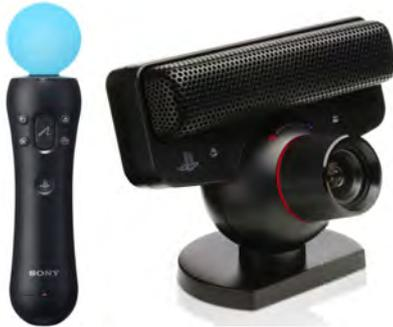
**Figura 45:** PlayStation Eye (dispositivo de visión por computadora) y PlayStation Move (reconocimiento de gestos)
