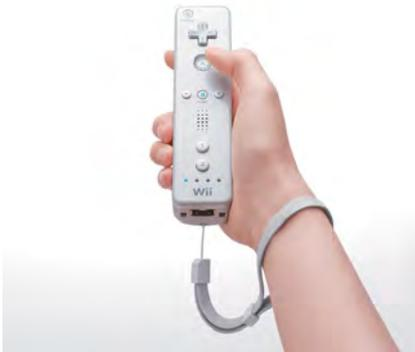
**Figura 46:** Wiimote, el controlador de la consola Wii que detecta el movimiento en el espacio y puede apuntar hacia objetos en la pantalla
