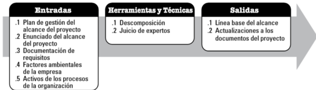
Figura 6.4: Crear el EDT: Entradas, Herramientas y Técnicas, y Salidas. Guía PMBOK [9].
