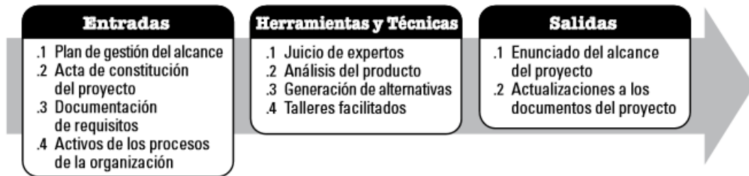
Figura 6.3: Definir el Alcance: Entradas, Herramientas y Técnicas, y Salidas. Guía PMBOK [9].
