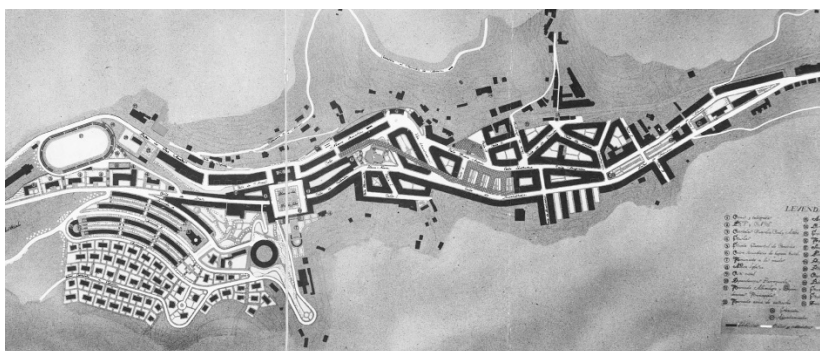
Fig. 3.5. Proyecto de Urbanización de Eibar, de Domínguez y Ponte (1940). En la zona oeste se observan dos tipos de crecimiento residencial; ciudad jardín y bloques lineales curvos siguiendo los niveles del terreno.
