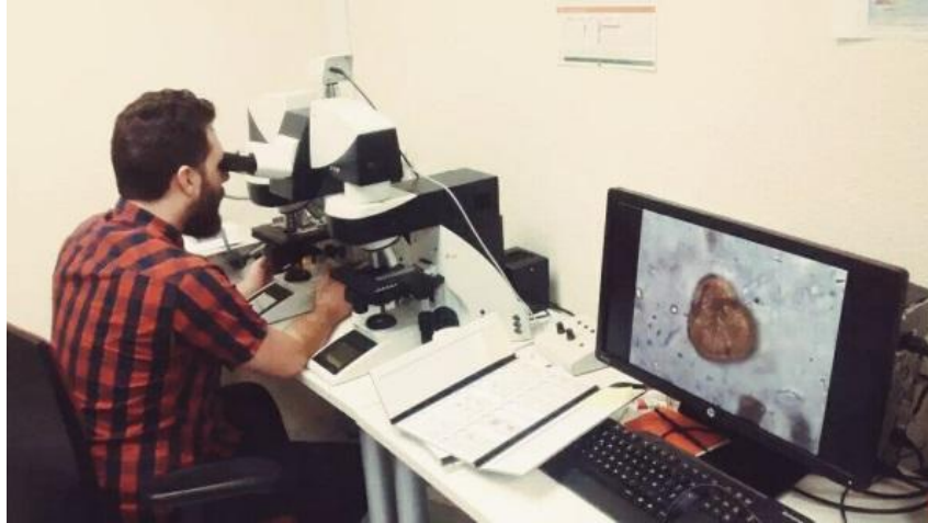
Figura 4.6. Identificación de las muestras polínicas mediante microscopio con puente de comparación Leica FS CB. El recuento de los palinomorfos ha sido apoyado mediante la colección de referencia del Instituto Pirenaico de Ecología (IPE-CSIC) ( http://herbario.ipe.csic.es/es/colecciones.php?col=15 ).
