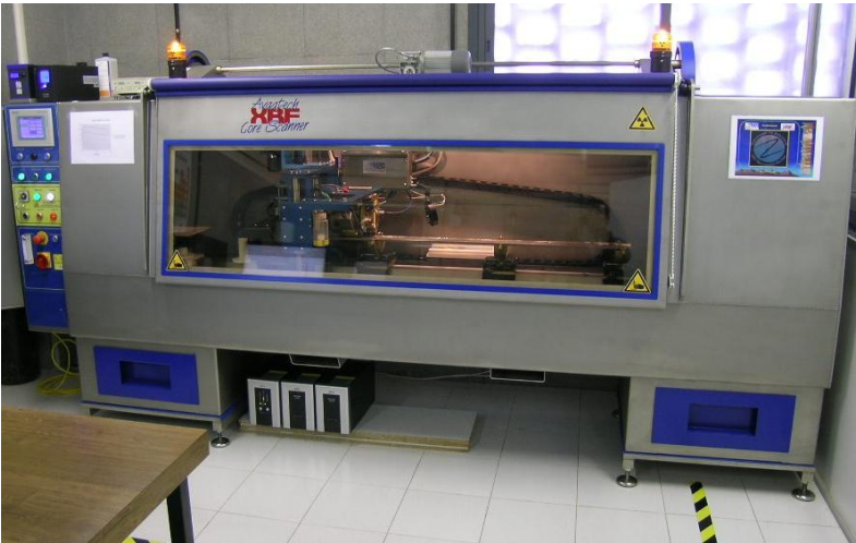
Figura 4.4. Escáner de fluorescencia de Rayos X (XRF), Avaatech XRF Core Scanner, del Departament d'Estratigrafia, Paleontologia i Geociències Marines de la Universitat de Barcelona
