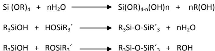
*Figura 2.6: Hidrólisis y condensación de los alcóxidos de Silicio.*
