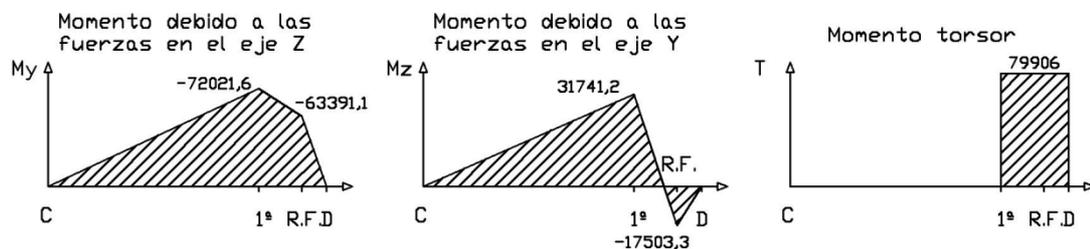
Para la aplicación del código ASME cogemos el momento flector máximo y el torsor máximo:
