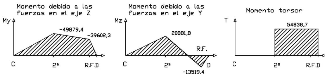
Para la aplicación del código ASME cogemos el momento flector máximo y el torsor máximo:
