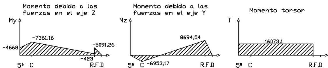
Para la aplicación del código ASME cogemos el momento flector máximo y el torsor máximo:
