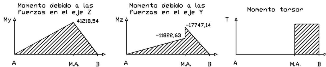
Para la aplicación del código ASME cogemos el momento flector máximo y el torsor máximo:
