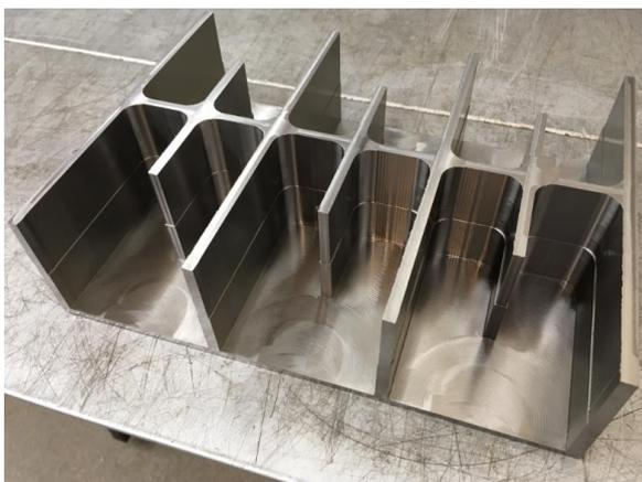
Ilustración 26: taco de pruebas desbastado
