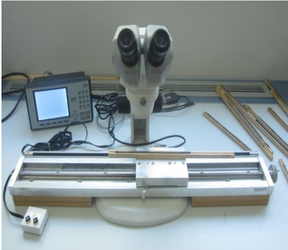
5. Irudia: Laginen datazio eta hazkunde-eraztunen lodieraren neurketarako erabilitako tresneria. Lupa binokularra eta VELMEX mikrometroa (0,001 mm-ko zehaztasuna).
