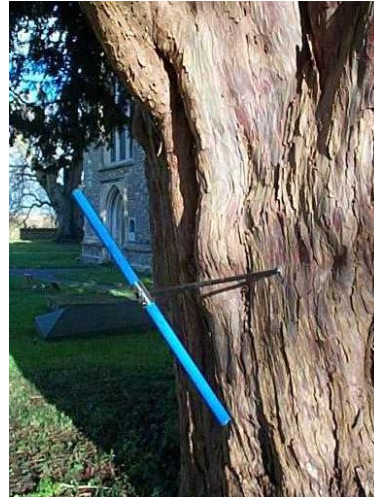
3. Irudia : Pressler barrena Taxus baccata ale baten enbor barnean. www.tree-ring.co.uk-etik lortuta.
