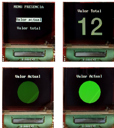
Figura 3.27: Vista del SubMenú Luminosidad (sup. izq.). Representaciones de la opción Valor Total (sup. dcha.) y opción Valor Actual cuando no hay detección (inf. izq.) y cuando sí hay detección (inf. dcha.).
