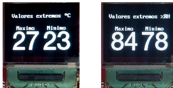
Figura 3.22: Representación de la opción Extremos para Temperatura (izq.) y Humedad (dcha.)
