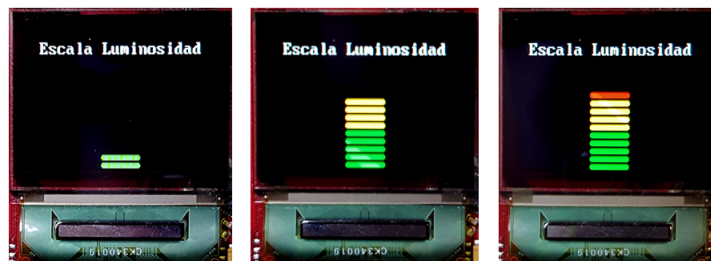
Figura 3.26: Representación de la escala de Luminosidad para tres valores diferentes. De izq. a dcha. valores ascendentes de Luminosidad.
