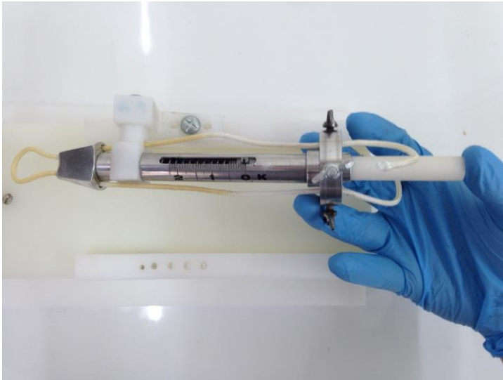
Figura 35. Demostración del funcionamiento del émbolo conectado al dinamómetro y al cable tractor. Obsérvense además las llaves de seguridad, que bloquean a voluntad el deslizamiento del cable y del émbolo.
