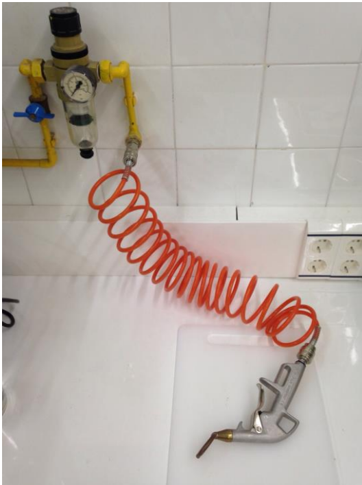
Figura 33. Dispositivo de aire a presión. Veáse la pistola conectada al circuito de aire motriz, con control de la presión (izquierda), y el aplicador circular multiperforado para la salida del aire a presión (arriba).
