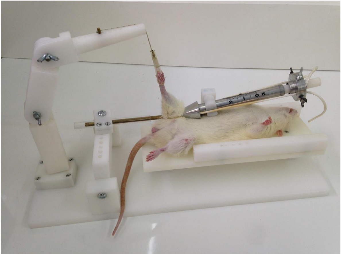
Figura 53. Dispositivo mecánico de cable a tensión para el mantenimiento de la isquemia. Vista inicial (primera fotografía) y en funcionamiento (segunda fotografía).
