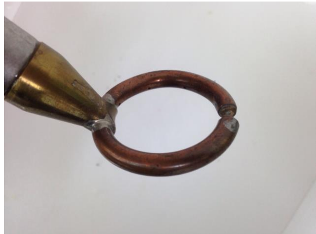
Figura 33. Dispositivo de aire a presión. Veáse la pistola conectada al circuito de aire motriz, con control de la presión (izquierda), y el aplicador circular multiperforado para la salida del aire a presión (arriba).
