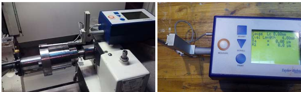
3-26. irudia: Taylor-Hobson etxeko rugosimetro eramangarria piezaren gainazalaren R_z zimurtasuna neurtzeko.
