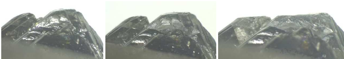
3-77. irudia: D2 diamantagailuaren goitiko ikuspegia 100., 225. eta 725. iraganaldietan, hurrenez hurren.
