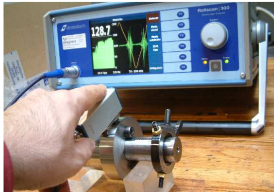
3-27. irudia: Barkhausen metodoaren bidez piezaren gainazaleko tentsio aldaketak neurtzen.
