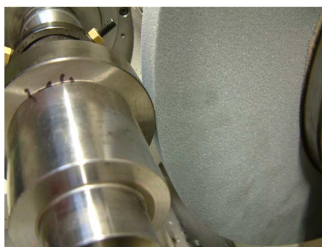
3-30. irudia: Artezketa prozesua (artezarriaren eta piezaren arteko kontaktua).
