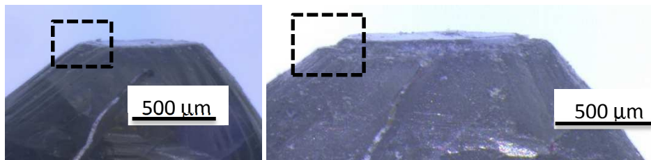
3-72. irudia: Higadura D4 diamantagailuan eta hausturak diamantagailuaren eta artezarriaren arteko lehen talkaren ingurunean.
