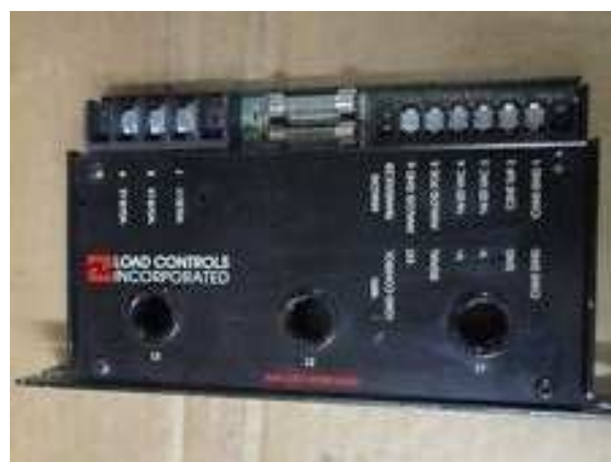
3-23. irudia: Potentzia kontsumo neurgailua (Load Control Inc.)
