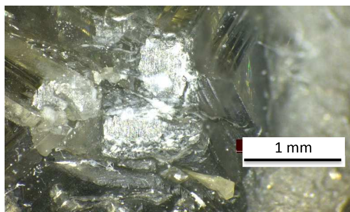
3-88. irudia: D2 diamantagailuaren higaduraren aurretiko irudiak 825. iraganaldian.
