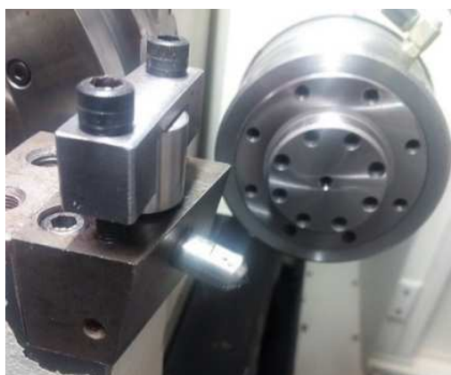
3-22. irudia: VS45H sentsorea diamantagailuaren euskarriaren gainean jarrita eta eutsita.
