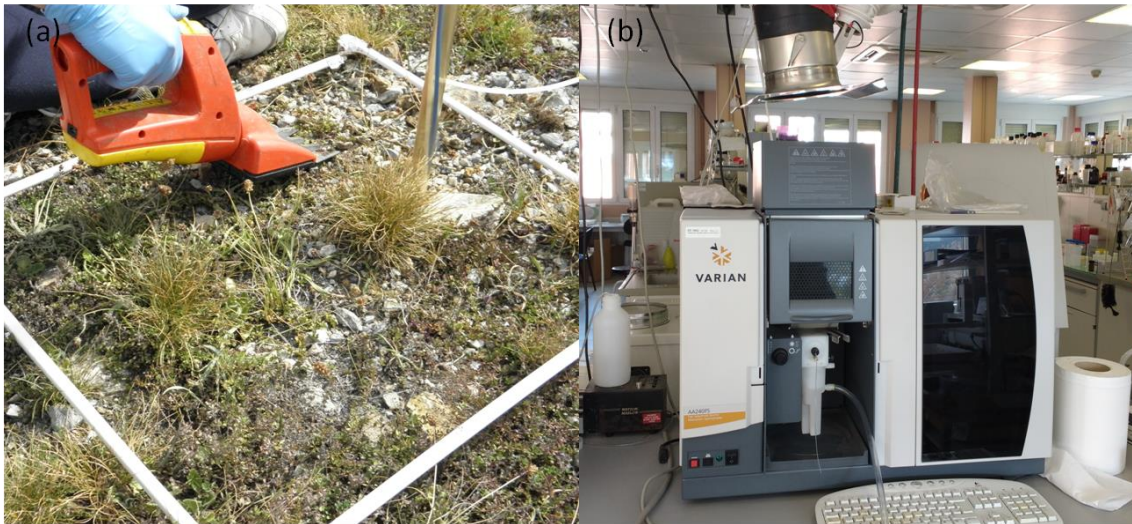
Figura 3.3: Determinación de metales pesados en planta: (a) toma de muestra de material vegetal; (b) espectrómetro de absorción atómica de llama. Fuente: NEIKER-Tecnalia.
