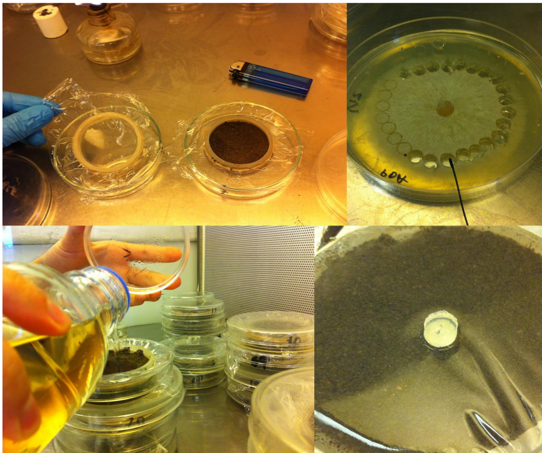
Figura 3.6: Determinación de supresividad con el test del anillo de agar. Fuente: NEIKER-Tecnalia.
