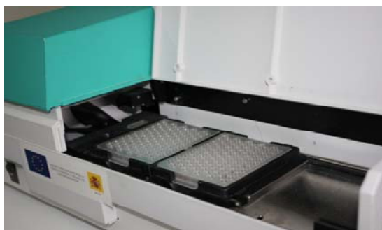
Figura 3.1: Incubadora microbiológica BioScreen C MBR y microplacas
