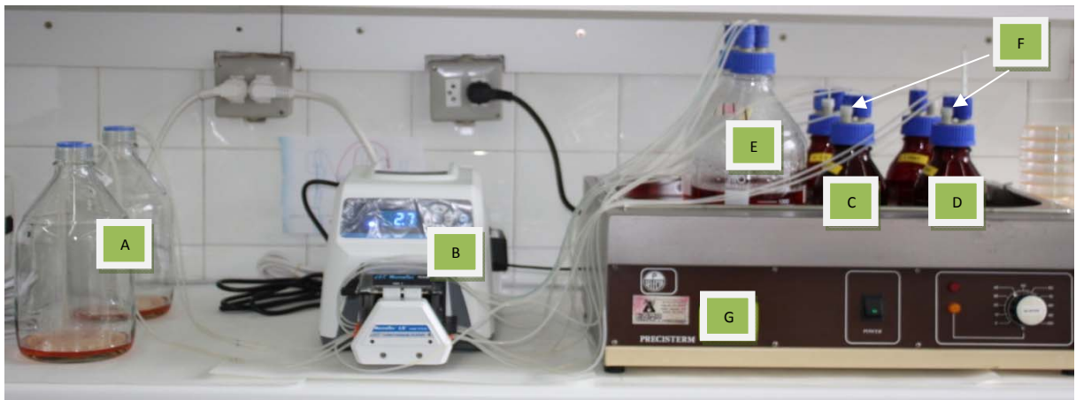
Figura 3.4: Modelo in vitro dinámico de Candida . A: Compartimento de desecho; B: Bomba peristáltica de múltiples canales; C: Compartimento central control; D: Compartimento central con fármaco; E: Recipiente que contiene el medio de cultivo para el suministro; F: Membrana de silicona a través del cual se introduce la levadura y/o el fármaco y desde donde se extrae la muestra; G: Baño termostático
