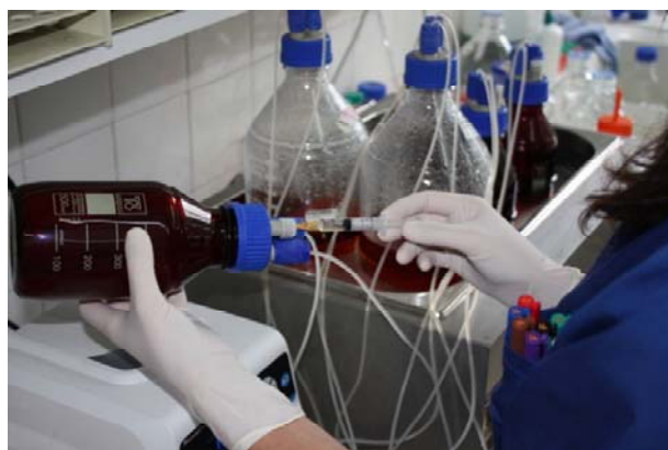
Figura 3.5: Recogida de muestras del compartimento central, con la jeringuilla, a través de la membrana de silicona
