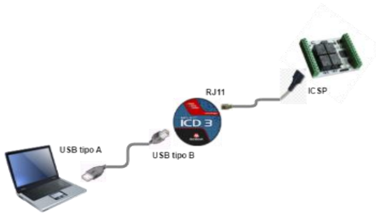
Ilustración 24: Diagrama de conexión para la programación del microcontrolador utilizando el debugger ICD
