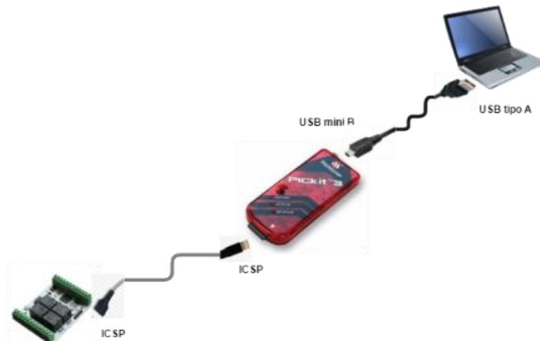
Ilustración 23: Diagrama de conexión para la programación del microcontrolador utilizando el debugger ICD
