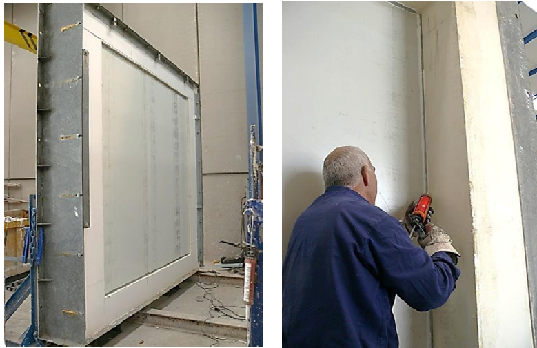
4.38 Irudia – Prestatutako barruko orria eta junta-zigilatzearen xehetasuna
