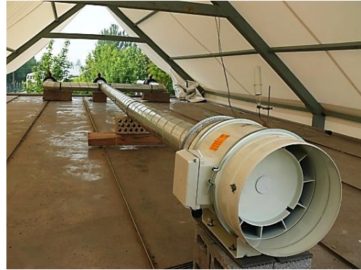
4.42 Irudia – Aireztatutako ganberaren behartuaren erauzketa sistema
