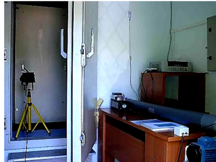
1.7 Irudia – Entsegu gela barruko azaleraren bukaera eta zerbitzu gelarekiko komunikazio hodiak
