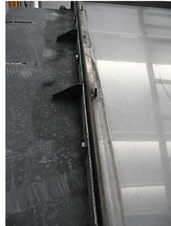
1.30 Irudia Zeldaren egiturako zigilatze junturak eta lagin-garraiatazaillearen ainguraketa bernoen xehetasuna
