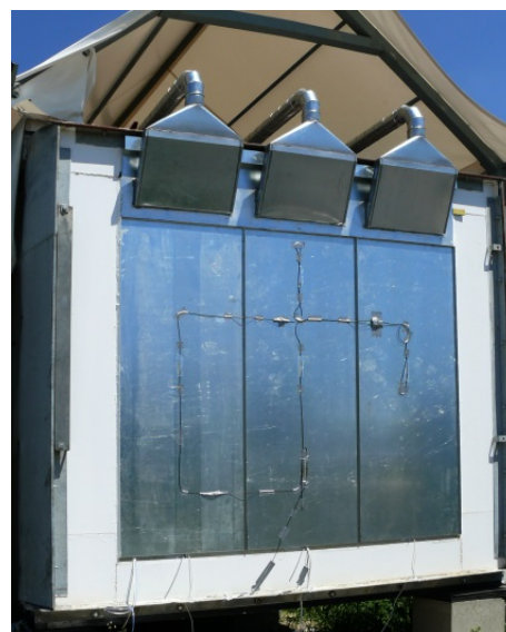
4.34 Irudia – Entsegu-probeta diseinua eta eraikitako lagina
