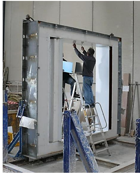
1.27 Irudian - PASLINK zeldaren lagin-garraiataile sistema
