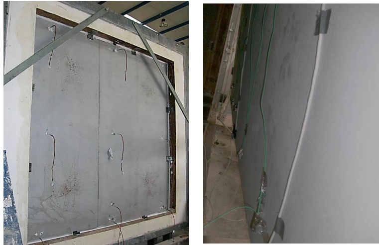
4.31 Irudia - Lagineko barruko aurpegia zundarekin aire-tenperaturako, ezkerre; aireztatutako ganberan jarritako termopila, eskuina
