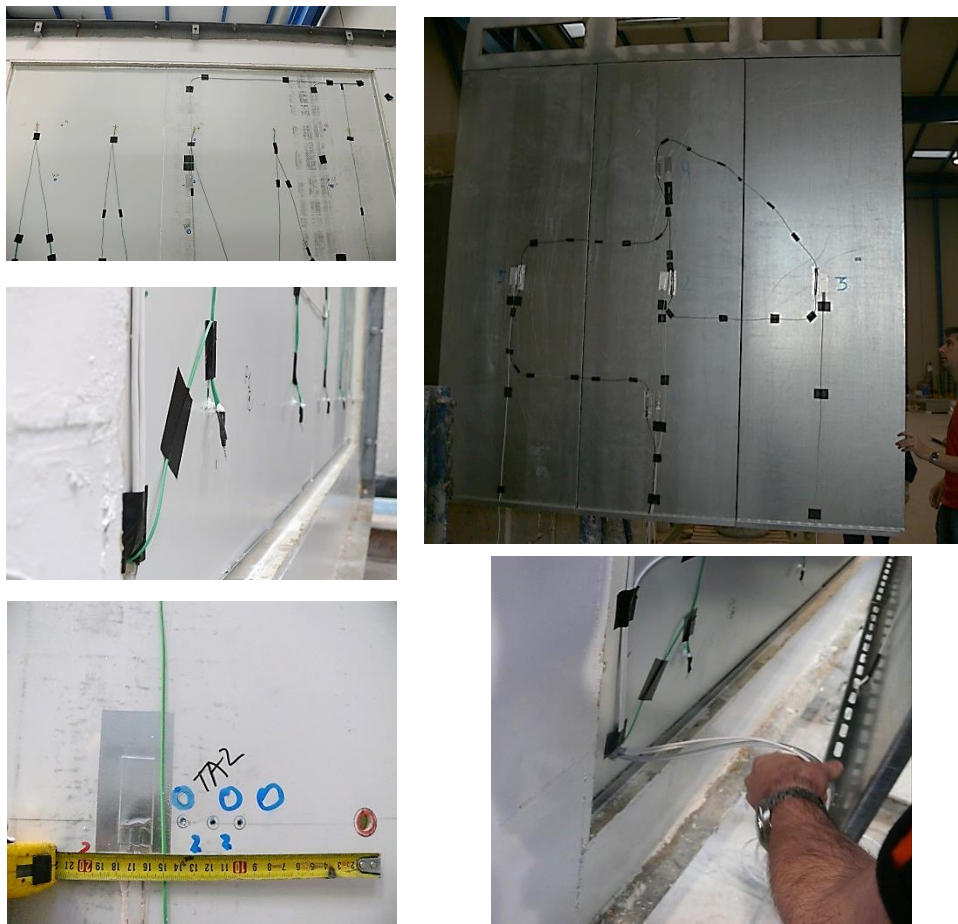
4.46 irudia - Fatxada behartuaren probetako zunden instalazio prozesua
