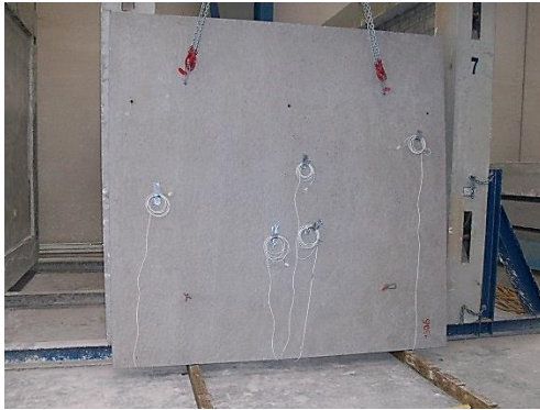
4.25 Irudia – Jarritako neurri instrumentazioarekiko hormigoi orria eta aireztatutako ganberaren eraketarako laguntza topeekiko oinarritzko horma
