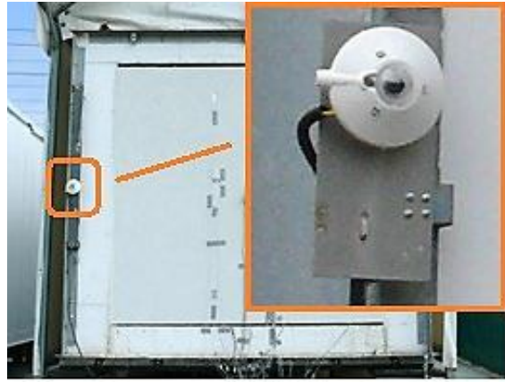
1.25 Irudia – Erradiazioaren osagai desberdinak neurtzeko piranometroak
