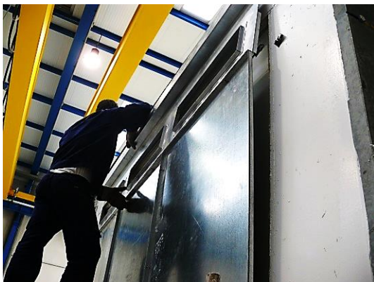
4.44 Irudia – Fatxada behartuaren azkeneko muntaketako prozesua
