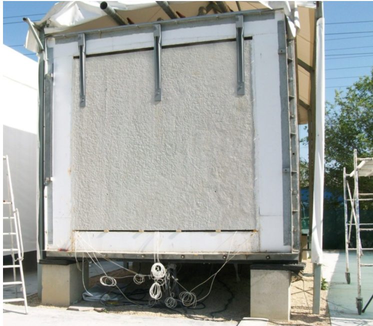
4.29 Irudia - Jarritako instrumentazioaren partearekiko azkeneko probeta
