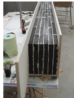
1.27 Irudian - PASLINK zeldaren lagin-garraiataile sistema
