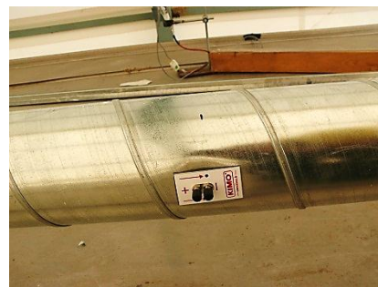
1.41 Irudia - Aireztatutako ganberako airearen berotzea neurtzeko termopilaren kalibrazioa
