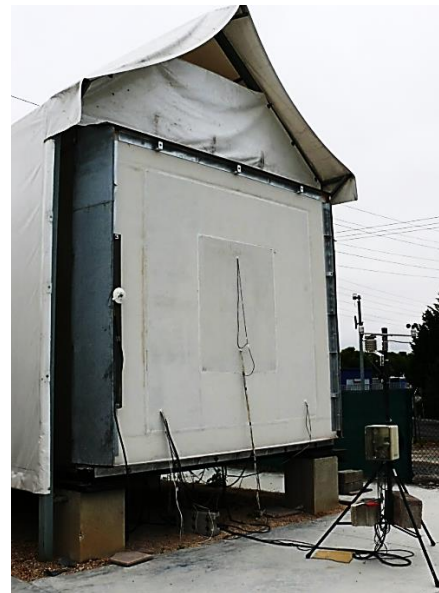
3.6 Irudia – Horma opakoaren osagai desmuntagarriaren fabrikazioa, eta EGUZKI gelaxkan lehenengo osagaiaren muntaketa
