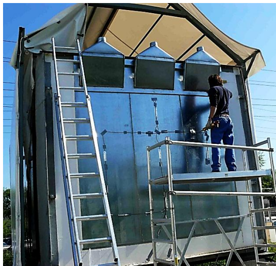
1.35 Irudia – Gelan jarritako probetaren gaineko azkeneko lanak
