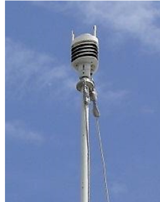
1.26 Irudia – Laginaren aurrean tenperatura zundak eta 10 [m]-ko altuerako ingurune-baldintzak
