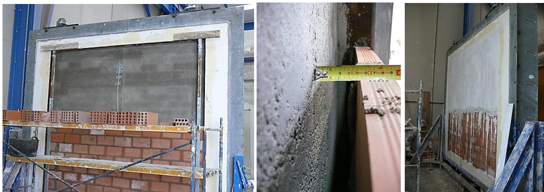
4.3 Irudia – Kanpoko orriko eraikuntza, aire-ganberaren lodieraren kontrola eta igeltsuko azkeneko estaldura
