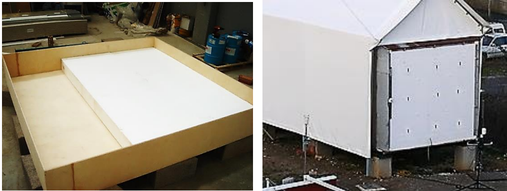
2.1 Irudia – Fabrikazioa eta kalibrazio-hormaren instalazioa
