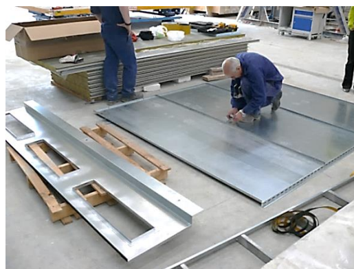
4.39 Irudia – Diseinua eta fatxada behartuaren lagineko kanpoko orriko muntaketa
