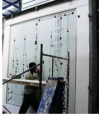
1.33 Irudia – Laginaren eraikuntza eta instrumentazioaren jartzea
