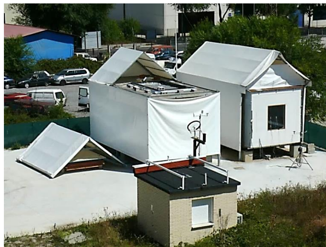
1.16 Irudia – EKRL-ko PASLINK entsegu zelden instalazioa
