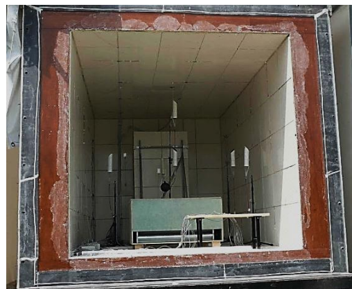
1.68 Irudia – Entsegu-gelako HFS Tiles-taldeen konfigurazioa eta multitiles-en kokapena
