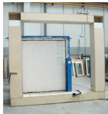
1.28 Irudia - Aurremarko isolatzailearen konfigurazioa
