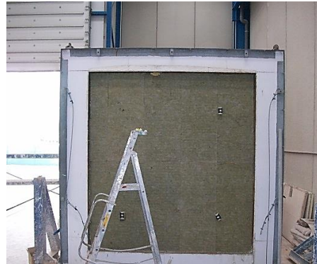
4.25 Irudia – Jarritako neurri instrumentazioarekiko hormigoi orria eta aireztatutako ganberaren eraketarako laguntza topeekiko oinarritzko horma
