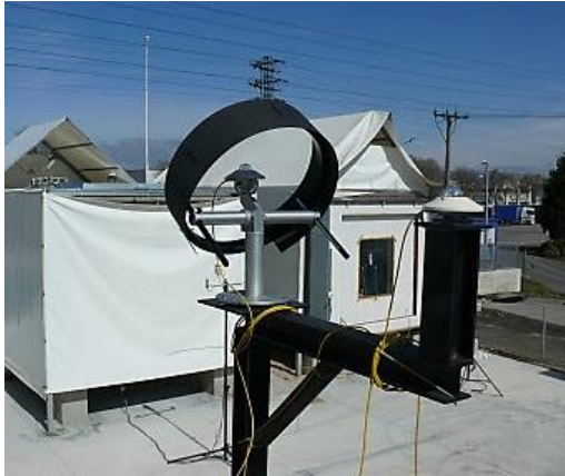
1.25 Irudia – Erradiazioaren osagai desberdinak neurtzeko piranometroak
