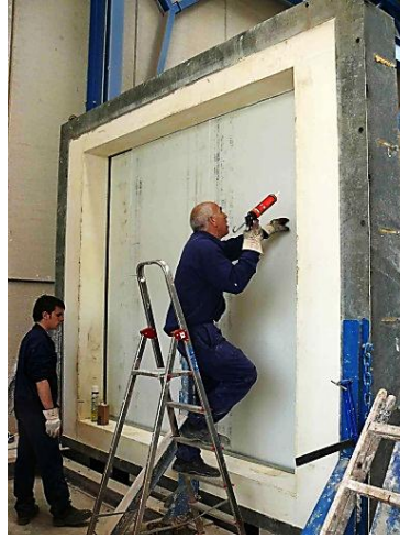
1.33 Irudia – Laginaren eraikuntza eta instrumentazioaren jartzea
