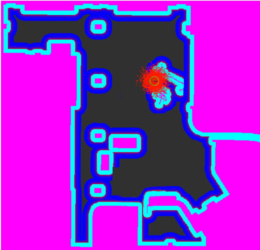
Figura 4.2: Vista en Rviz del mapa de la zona. El color rosa representa el obstáculo y los azules su inflación. El círculo verde es la base del robot. Los puntos rojos son la dispersión de las partículas del algoritmo AMCL.
