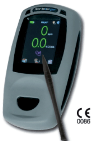
Ilustración 2: Cooxímetro Bedfont Micro+ Smokerlyzer Hand Held
