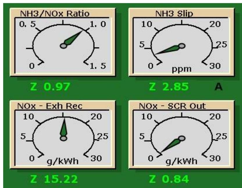
Figura 26 Relación de NH<sub>3</sub>/NO<sub>x</sub> ajustado (Simulador Kongsberg MC90-V)
