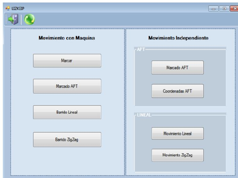
*Fig. III.16: Software propio desarrollado para el control de los ejes del escáner y el láser durante el proceso de TLE*
