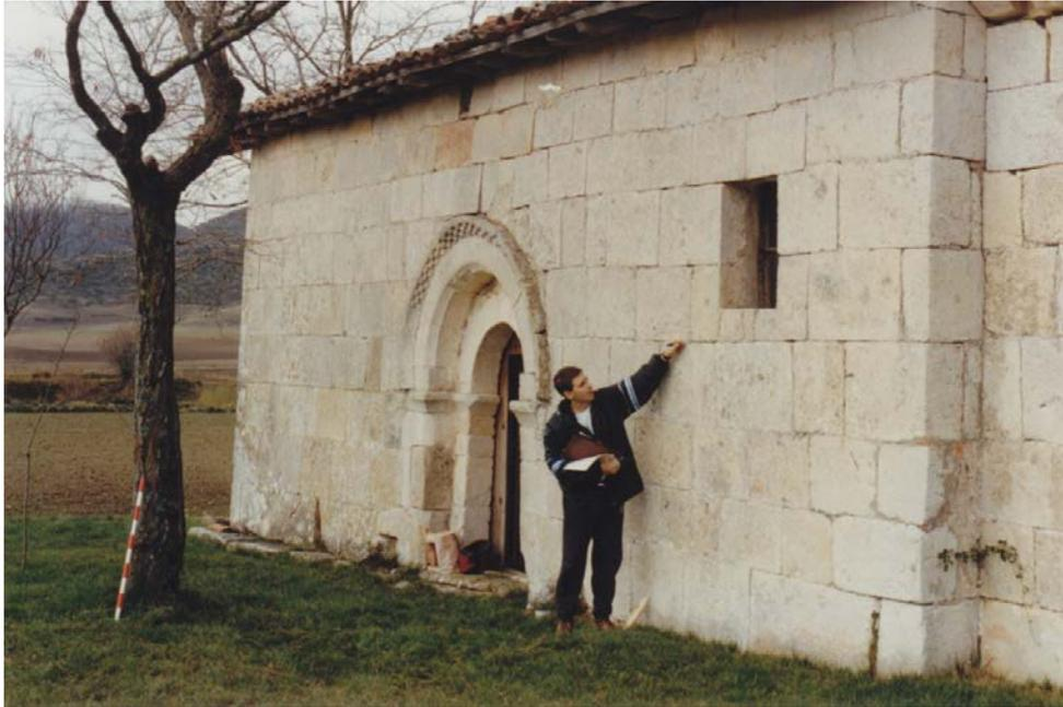
Fig. 2.- Marcado de puntos destacados en campo para su captura con estación total.
