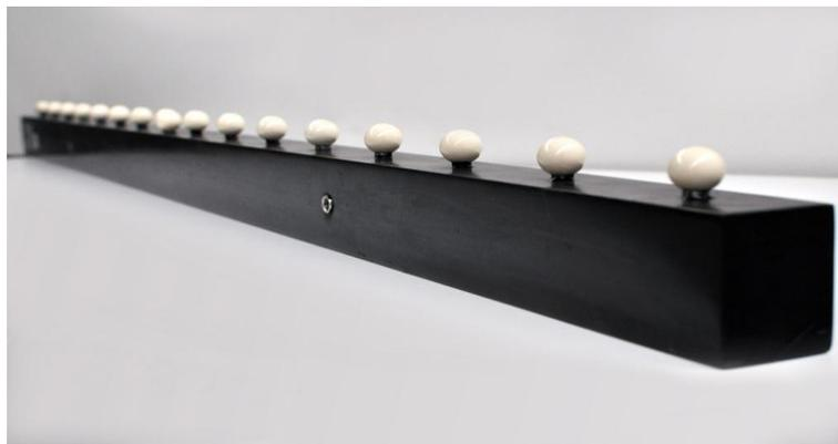
Figura 12.- Barra de bolas de calibración.
