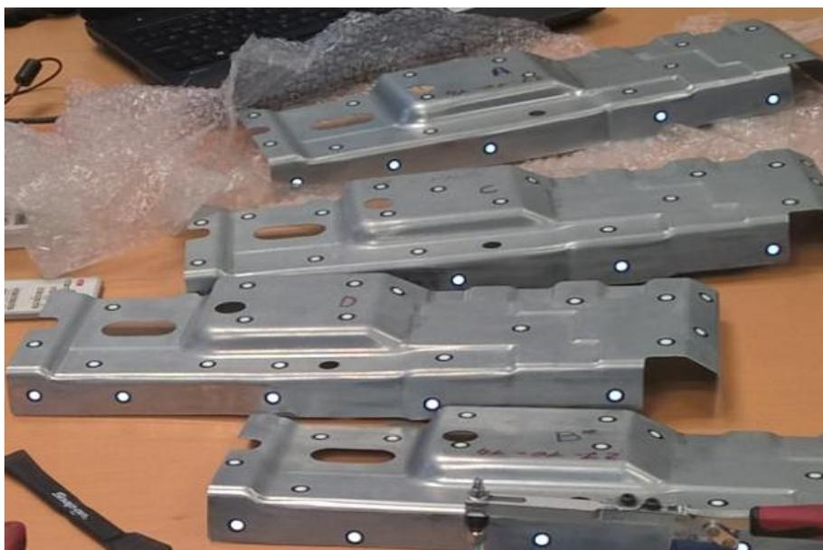
Figura 37.- Colocación de las pegatinas en las piezas.
