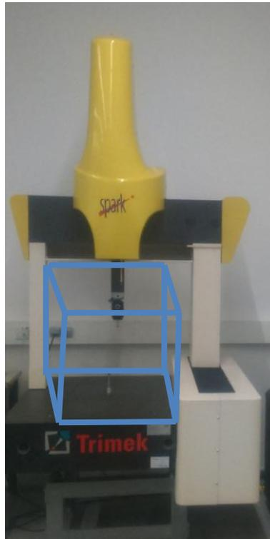
Figura 7.- Volumen Útil de la MMC.
