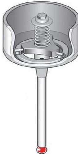
Figura 9.- Interior de la sonda de disparo.
