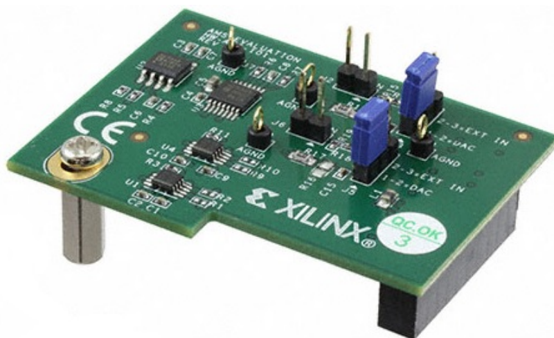
4.3 Irudia: AMS101 ebaluazio txartelaren hardware oinarria.
