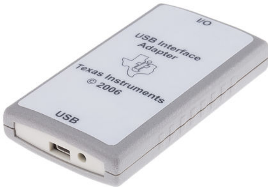
4.5 Irudia: Tiren PMBUS-USB bihurtailua
