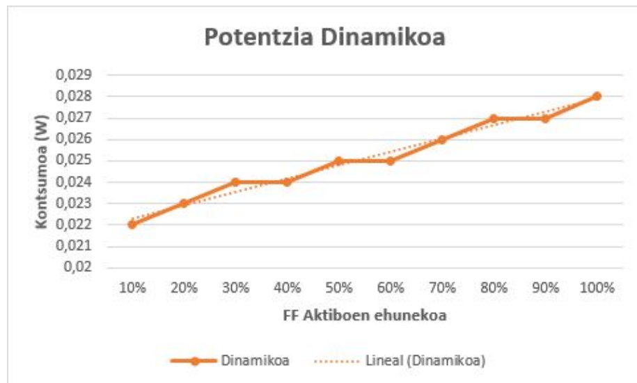
6.7 Irudia: 2. Saiakeraren Potentzia dinamikoaren grafikoa
