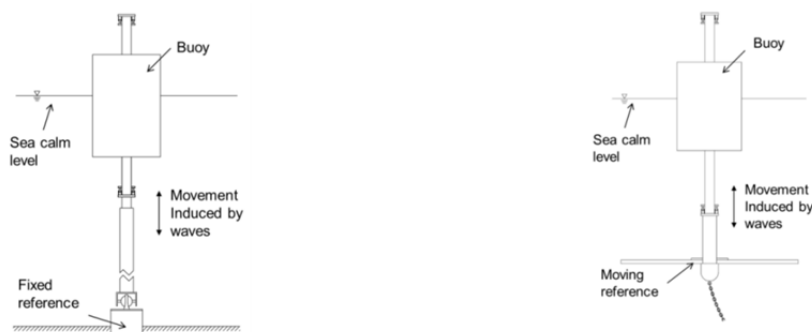
Figura II. 6. WEC absorbedor puntual con referencia fija (izda), Eidsmoen (1996b), y con referencia móvil (dcha), Eidsmoen (1996a)
