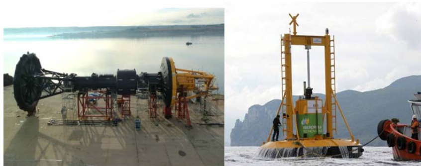
Figura II. 9. Convertidor Powerbuoy. Cortesía Ocean Power Technologies.
