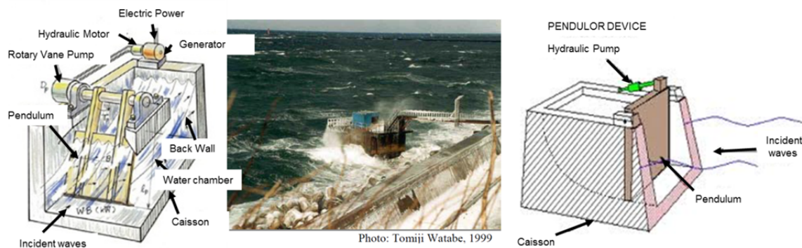
Figura II. 13. Convertidor Pendulor. (Watabe, 1999)
