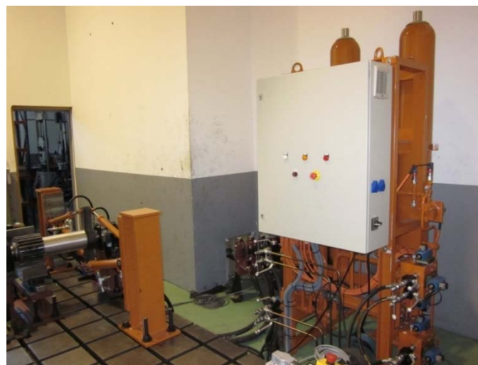
Figura III. 5. PTO y armario de control.
