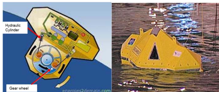
Figura II. 12. Convertidor SEAREV. Cortesía Escuela Central de Nantes.
