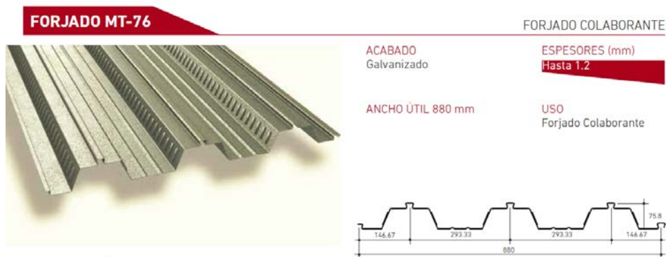
Figura 46. Detalle del forjado de chapa colaborante.
