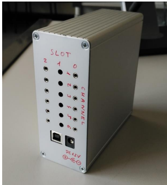
Figura 5: Sistema de monitorización de estructuras SHMUS
