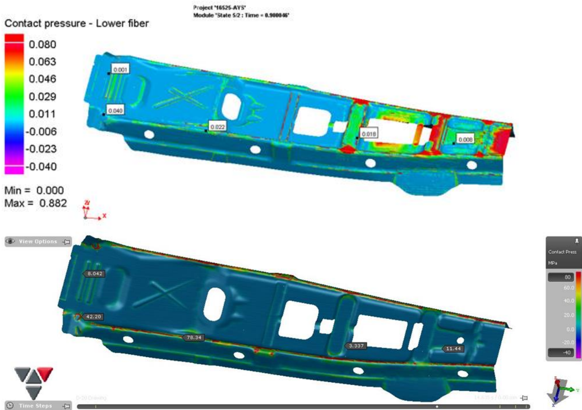
Irudia 127 Quenching etaparen hasierako presioa (behean MPa, goian GPa)
