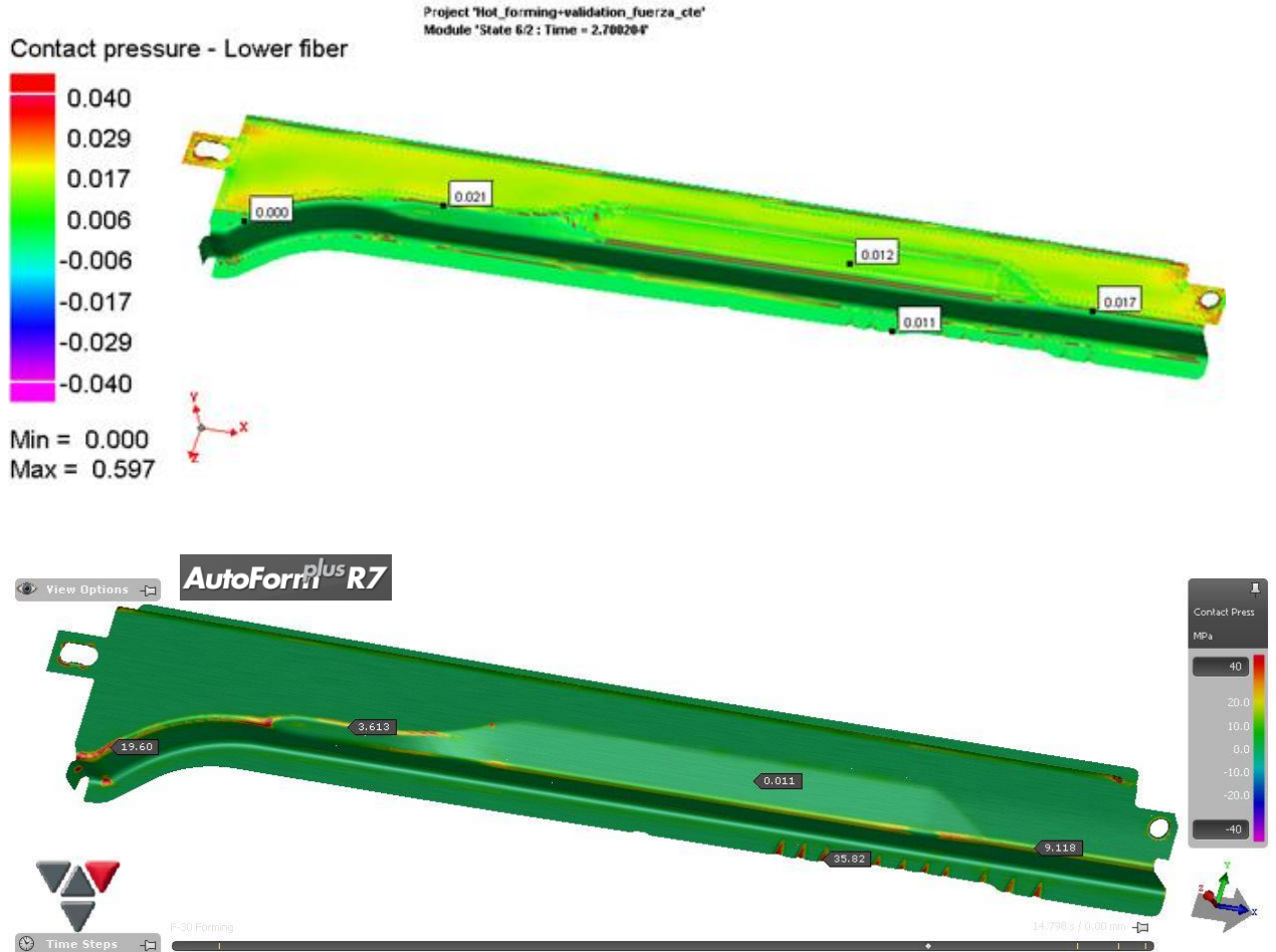
Irudia 120 Presio kontaktua quenching aurretik Pam Stamp/Autoform
