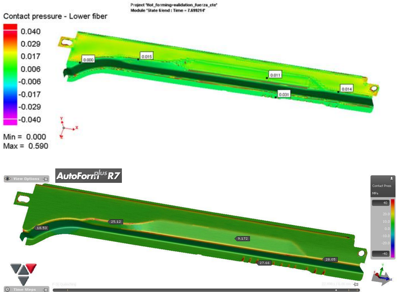
Irudia 121 16510 piezaren quenching bukaerako kontaktu presioa
