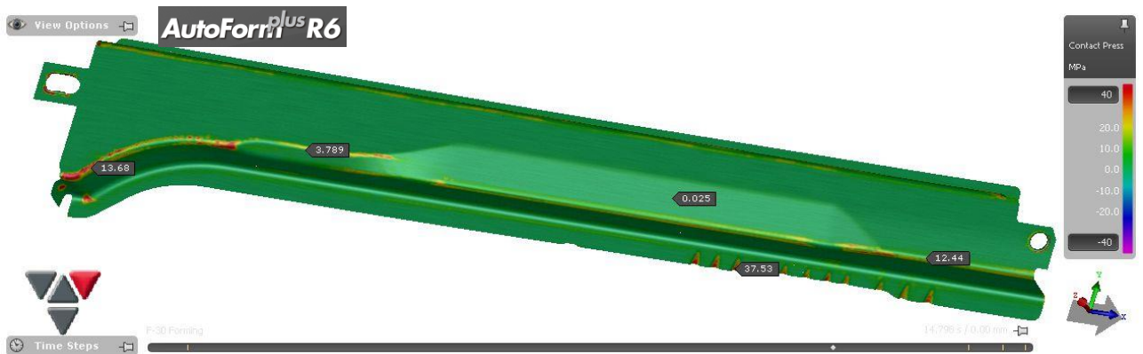
Irudia 80 16510 piezaren quenching etaparen hasierako kontaktu presioa R6
