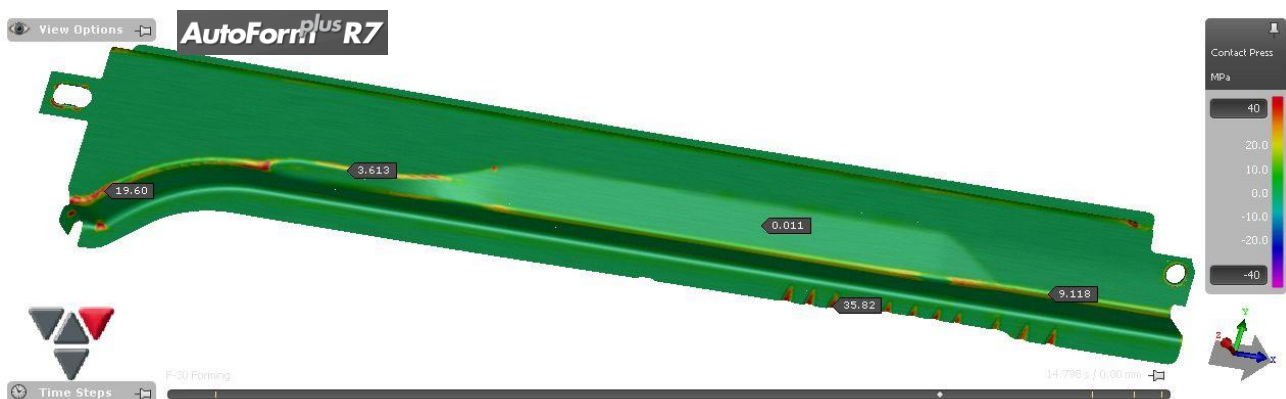
Irudia 81 16510 piezaren quenching etaparen hasierako kontaktu presioa R7
