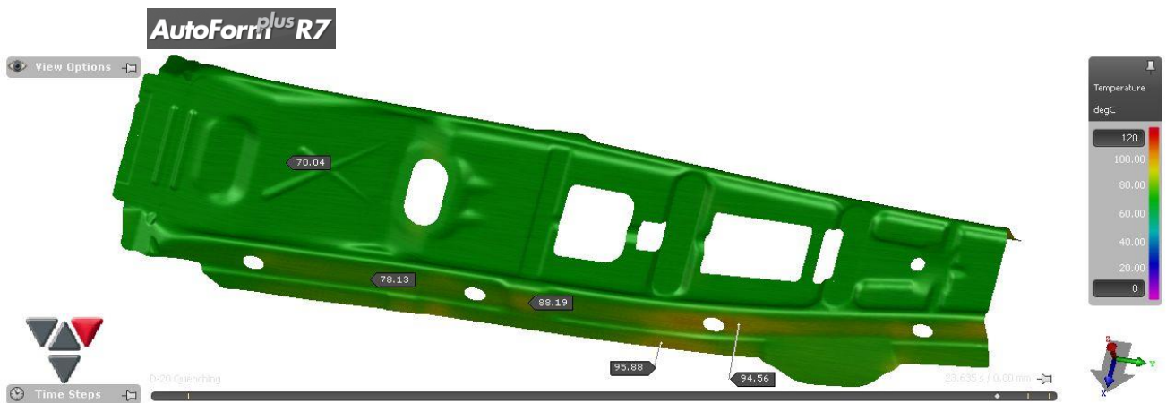
Irudia 104 Quenching etaparen bukaerako temperatura R7
