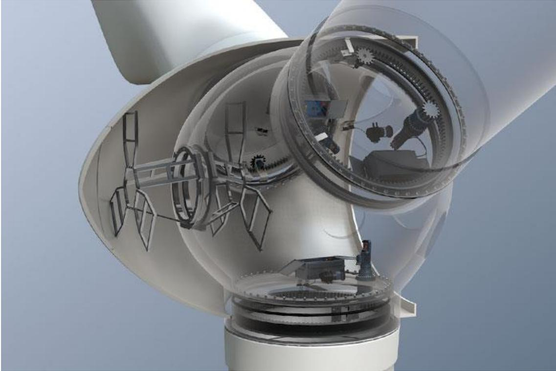
*Ilustración 2.5-2 Sistemas de orientación de Aero y palas*
