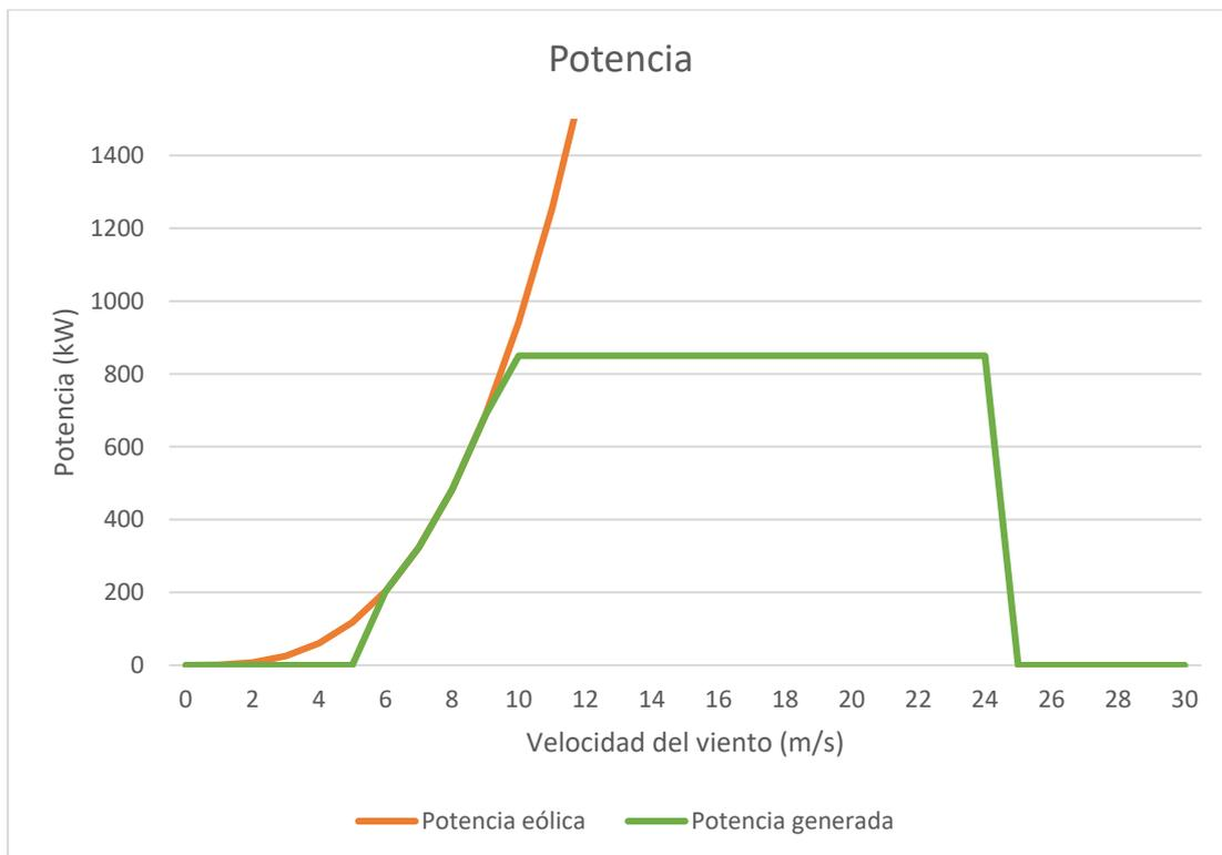
Ilustración 4.1-2 Curva de potencia del aerogenerador
