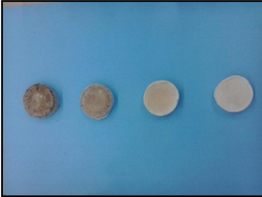
*Figura 2.3. Soportes porosos de PCL con 80, 70, 30, 10% de nHAFé de izda a dcha.*
