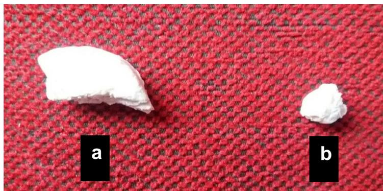
Figura 5.9.- Fotografía de PLLA-10%nHAFé (a) sin degradar y (b) 25 semanas degradado en PBS.
