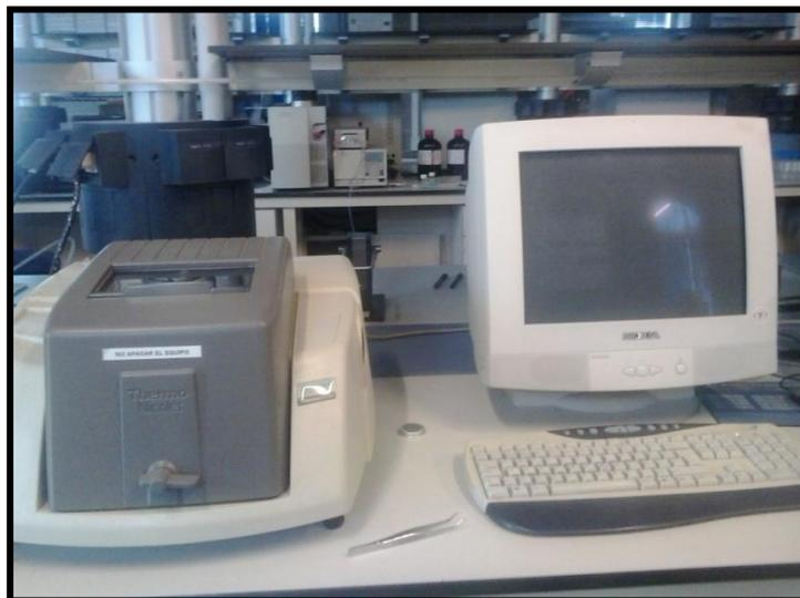
*Figura 2.8.- FTIR Thermo Scientific Nicolet Avatar 370 equipado con ATR, Pike Smart MIRacle*
