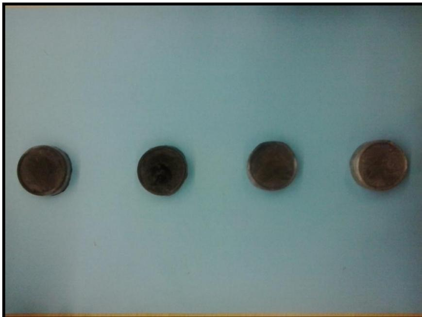
*Figura 2.6. Soportes porosos de PLLA con 50, 30, 20 y 10% de nFe<sub>3</sub>O<sub>4</sub> de izda. a dcha.*
