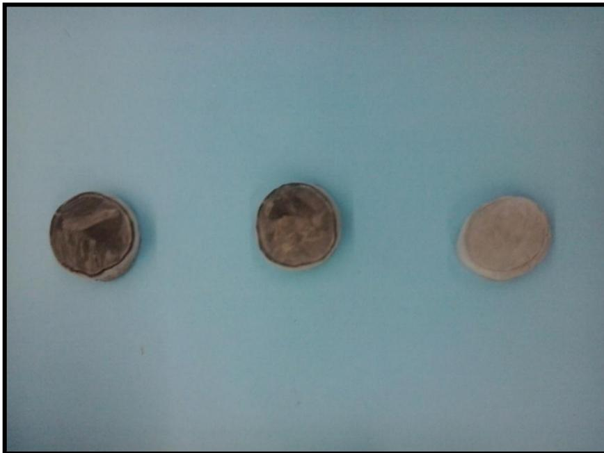
*Figura 2.4. Soportes porosos de PCL con 20, 15 y 5% de nFe<sub>3</sub>O<sub>4</sub> de izda a dcha.*
