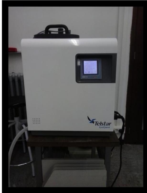
*Figura 2.- Liofilizador Telstar Lioquest 85 utilizado para la obtención de soportes porosos magnéticos*
