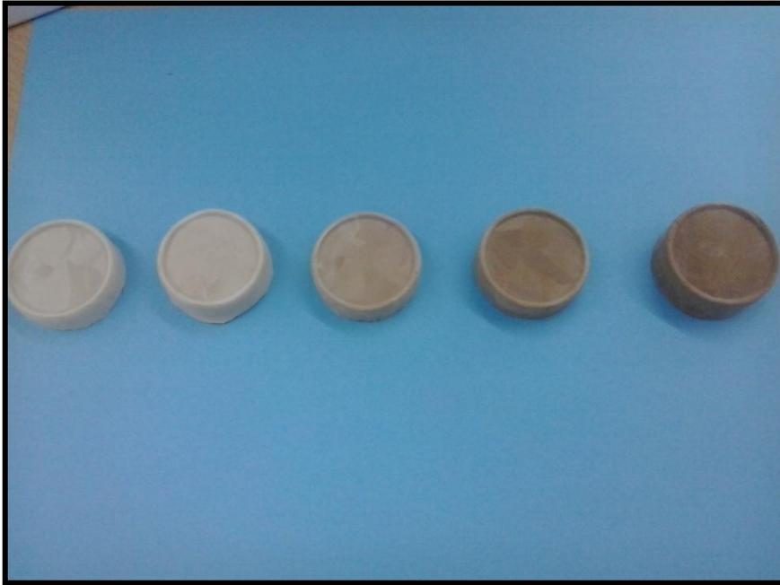
*Figura 2.5. Soportes porosos de PLLA con 10, 20, 30, 50 y 70% de nHAFc de izda. a dcha.*
