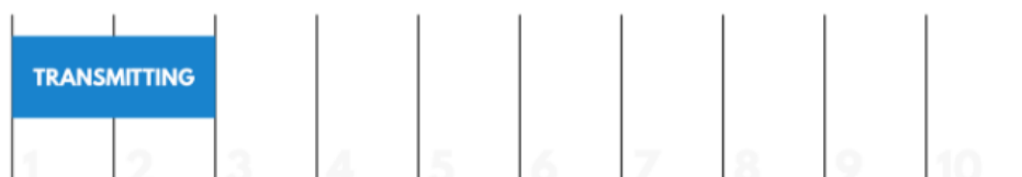
Figura: 3.7. Dispositivo enviando en un solo canal.
