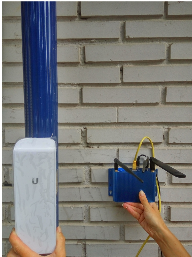
Figura: 6.19. Antena direccional de 5 Ghz y gateway.
