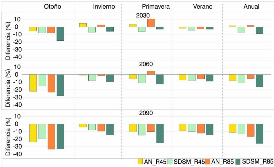
Figura 4.26. Diferencia (%) entre las proyecciones hidrológicas futuras y su base para Audikana. Para agrupar la diferencia en función del RCP (4.5 y 8.5) y el método de downscaling (SDSM o AN) se ha calculado el valor medio de la diferencia. Los datos aparecen separados en función de los horizontes 2030, 2060 y 2090 y en valores estacionales y anuales.
