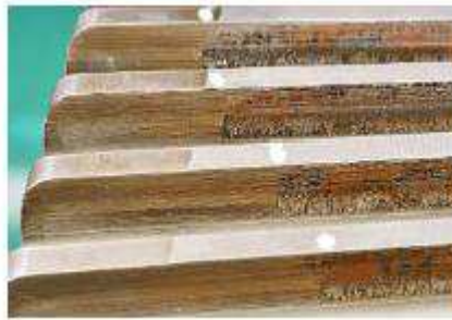
Irudia 3.22: Hortzen desgastea marruskaduraren eraginez
