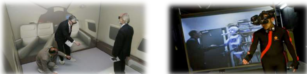
IMÁGENES 1.12 y 1.13: Sistemas semi-inmersivos de RV. A la izquierda, un sistema con forma de cubo. A la derecha, un hombre que utiliza gafas y un casco de seguimiento de movimientos de la cabeza para disfrutar de una experiencia semi-inmersiva.
