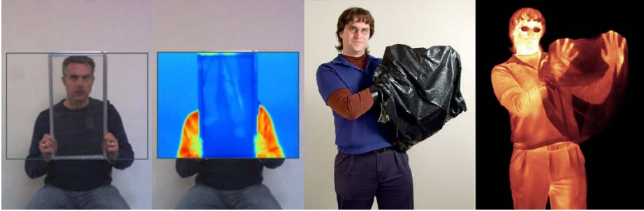
6.17 Irudia. Beiraren opakotasuna (ezkerrean) eta plastiko poltsa baten gardentasuna (eskuinean) infragorrientzat (Internet).
