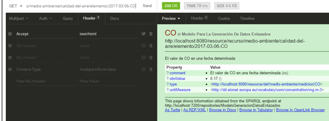
Figura 12: Petición a Servidor Linked Data solicitando recurso en formato HTML desde INSOMNIA
