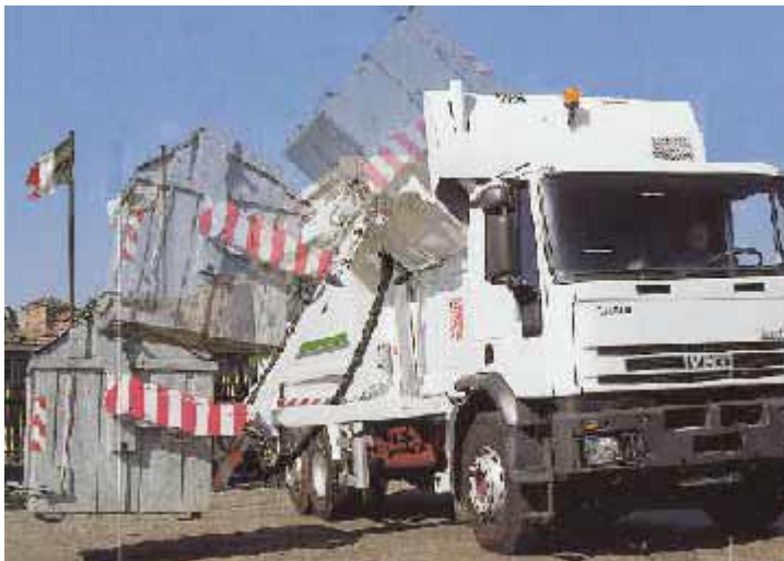
Figura 3.4. Camión con mecanismo de carga lateral
