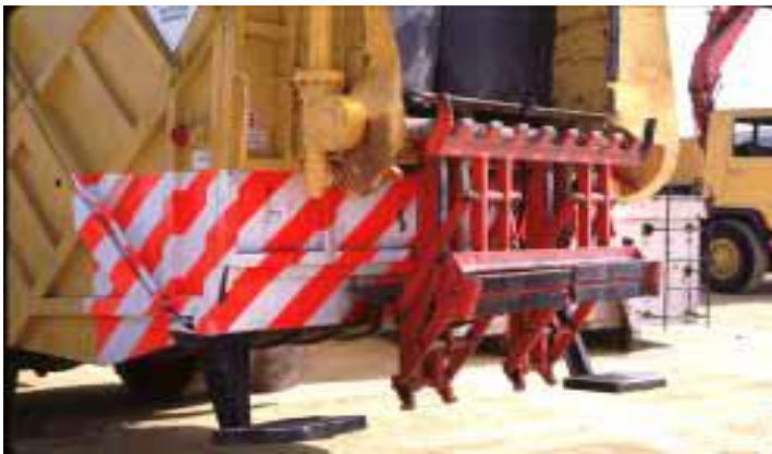
Figura 3.3. Camión con mecanismo de carga trasera
