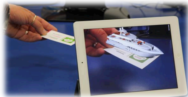
IMAGEN 1.23: RA basada en marcadores. La aplicación escanea un marcador que contiene la imagen 3D de un yate.
