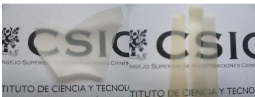
Figura 4. Fotografías del filme sin irradiar (izquierda) y de las probetas para los ensayos de pruebas mecánicas del filme irradiado a 354 nm (derecha). Los filmes irradiados a 354+254 nm y 354+254+354 nm mostraron la misma apariencia que el filme irradiado a 354 nm.
