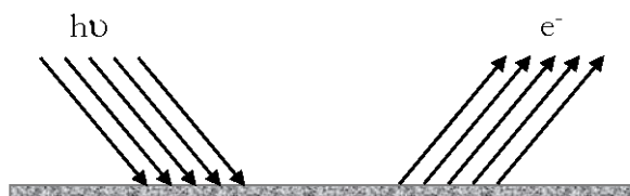
Figura 2.8. Esquema del efecto fotoeléctrico.
