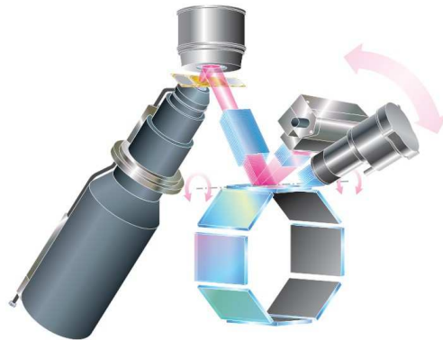
Figura 2.5. Diagrama del espectrómetro de fluorescencia de rayos X de dispersión por longitud de onda.
