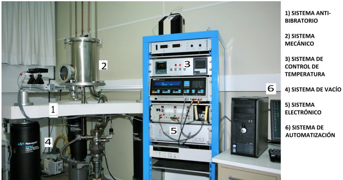
Fig.3. 1: Péndulo de torsión invertido Gorbea. El sistema criogénico se coloca alrededor de la barra que desciende del sistema mecánico.
